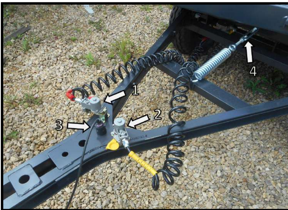
Fot. 2 – Złącza dostępne z przodu przyczepy: 1- złącze zasilające instalacji pneumatycznej (czerwone); 2- złącze sterujące instalacji pneumatycznej (żółte); 3- złącze instalacji elektrycznej; 4- śruba regulująca wysokość dyszla.
