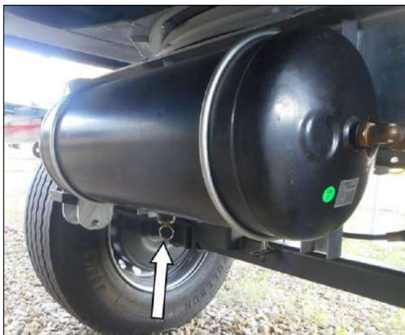
Fot. 11 – Położenie zaworu odwadniającego w zbiorniku.
