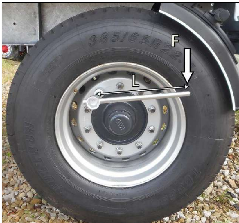
Fot. 13 – Dokręcanie nakrętek koła
