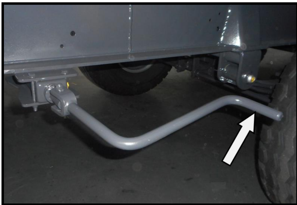
Fot. 18 – Pokrętło hamulca postojowego
