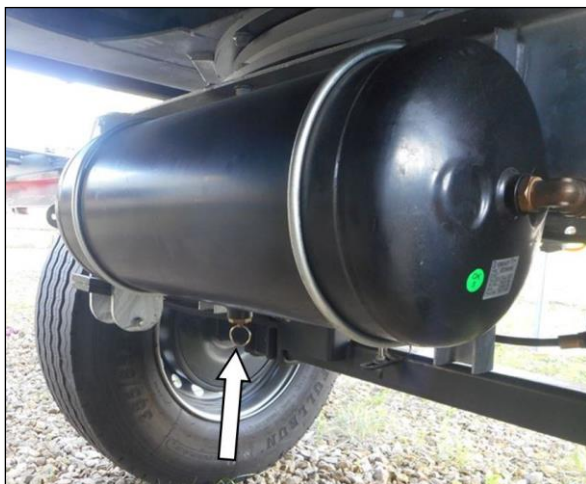
Fot. 11 – Położenie zaworu odwadniającego w zbiorniku.
