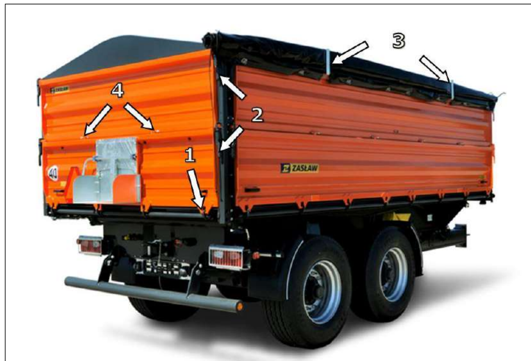
Rys. 17 - Położenie zawiasów i zamków burt w przyczepie
