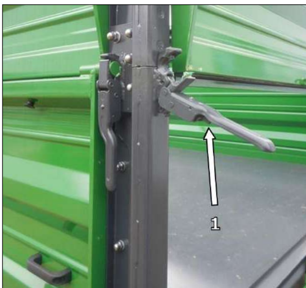
Rys. 24 - Otwieranie dźwigni zamków burt.
