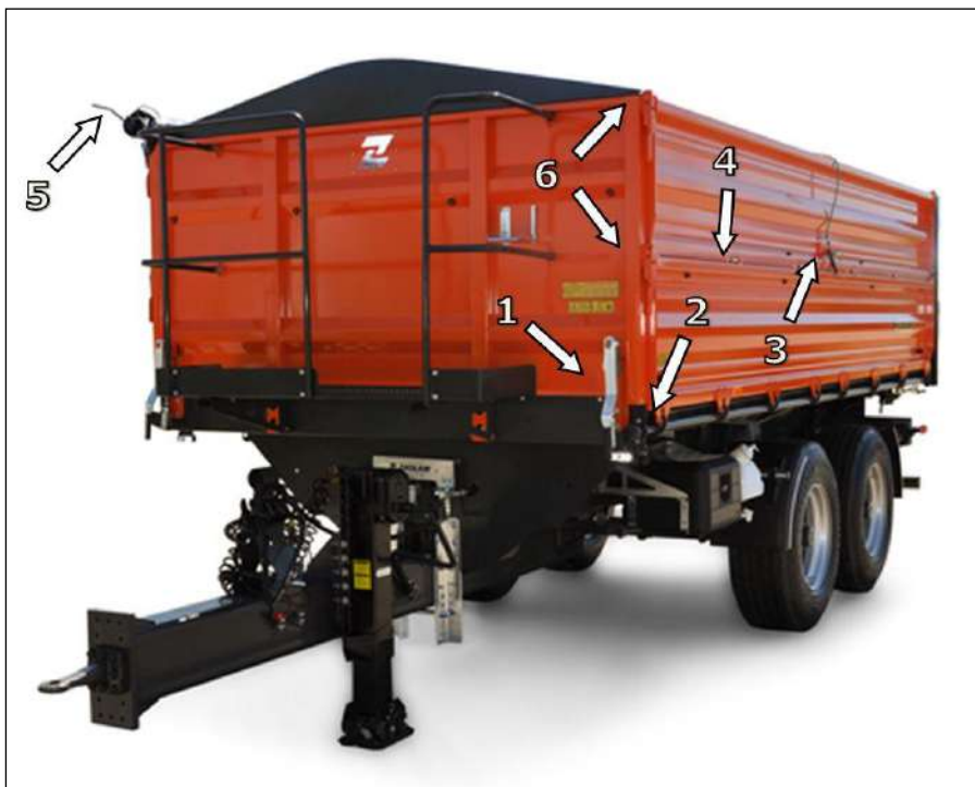
Rys. 18 - Położenie zawiasów i zamków burt w przyczepie
