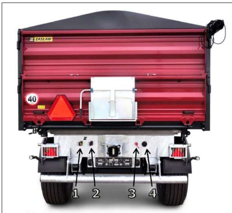
Rys. 16 - Złącza dostępne z tyłu przyczepek
