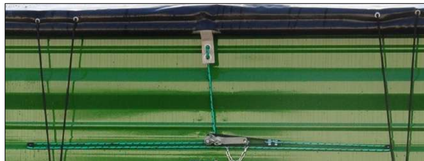
Rys. 22 - Ułożenie linki do rozwijania plandeki.
