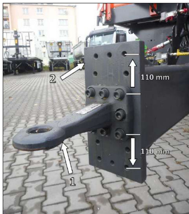
Rys. 31 Regulacja oczka pociągowego
