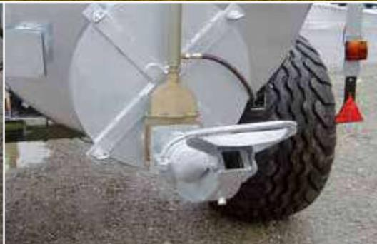
Kombiverteiler – klappbar
