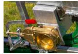
Staukasten zum separieren von Fremdkörpern
