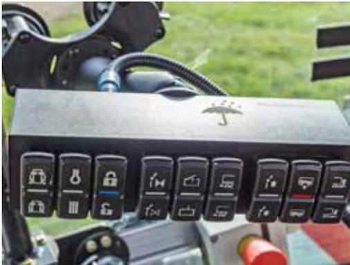
Bedienpult für Skate-Verteiler und Fass
