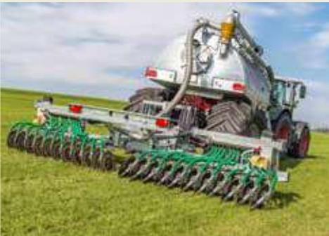
Durch die schräglage der Scheiben wird der Boden für die Direkteinbringung der Gülle geöffnet
