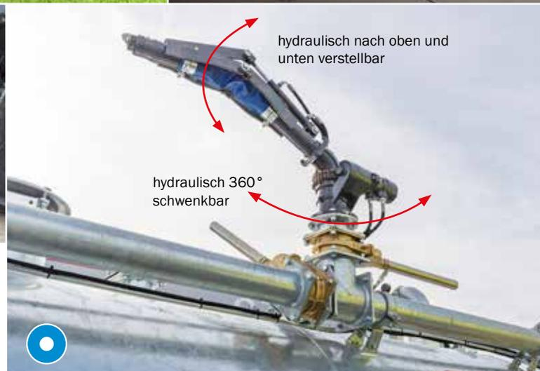
hydraulisch nach oben und unten verstellbar
