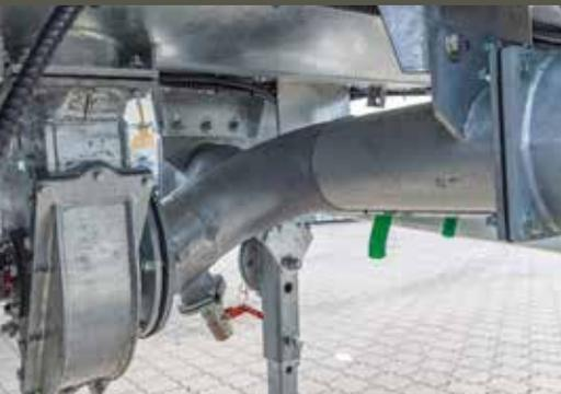
**Turbobefüller mittig unter Fass**
