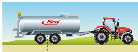
Optimale Anpassung der Stützlast durch mechanische Achsverschiebung oder stufenlos hydraulisch (optional). Auch bei Montage von Gülleverteiler wie z.B. Schleppschuh
