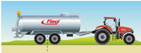
Optimale Anpassung der Stützlast durch mechanische Achsverschiebung (Serienausstattung) oder stufenlos hydraulisch (optional). Auch bei Montage von Gülleverteiltern wie z.B. Schleppschuh
