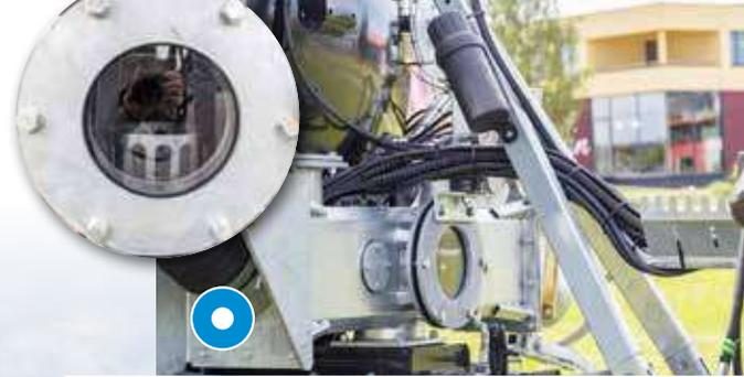
Pumpenkasten mit Schauglas und Fremdkörperabscheider
