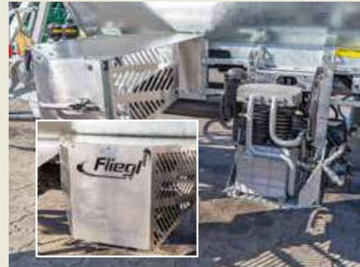
Kolbenkompressor mit bis 3,3 m<sup>3</sup> Luftleistung
