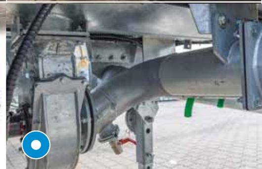
Turbobefüller hydraulisch, mittig unter dem Fass
