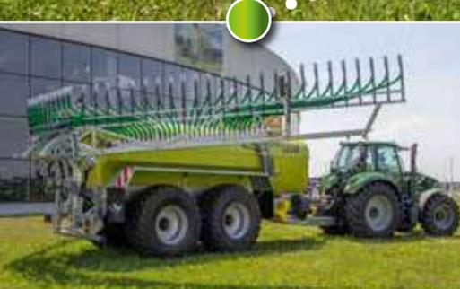
Keine abknickende Auslaufschläuche durch speziellen Klappmechanismus
