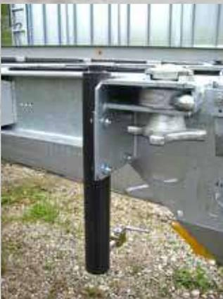
Zylinder für hydraulische Hebeeinrichtung
