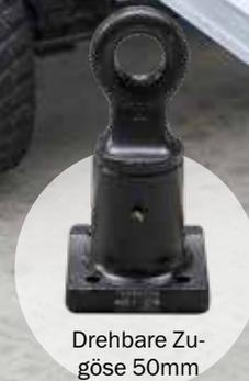
Drehbare Zugöse 50mm
