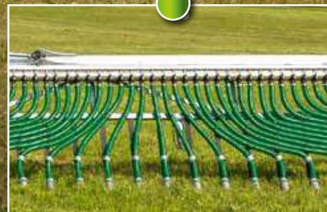
Gleichmäßige Verteilqualität durch kurze Auslaufschläuche
