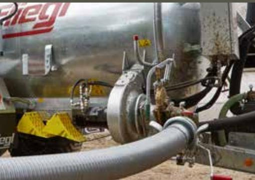
**Turbobefüller mit Schnellkuppler (6“ oder 8“)**
