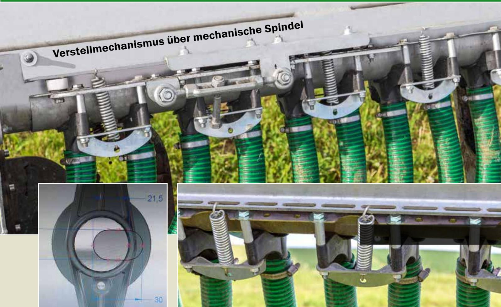
Federspannvorrichtung des Schneckenverteilers FlexFlow
