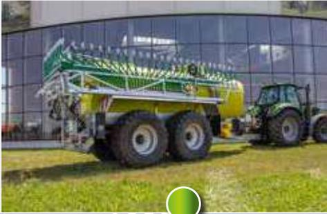
Extrem kompakte Transportbreite von unten 2600 mm und oben 2300 mm
