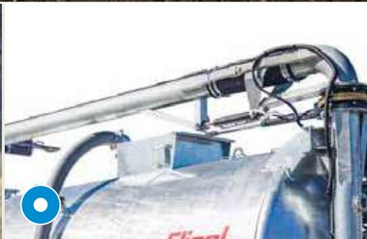
Absaugarm hydraulisch schenkbar 8"
