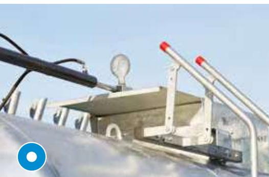
Bei Pumpfass: Hydraulischer Schubdeckel
