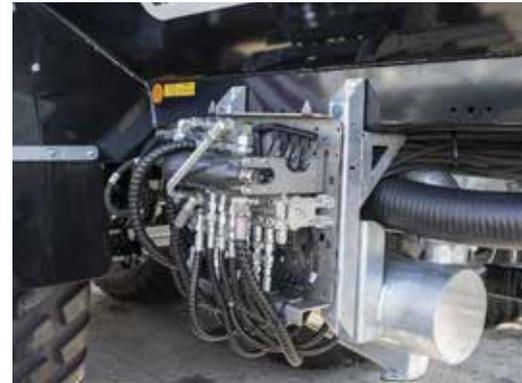
Steuerblock Load Sensing oder Konstantstrom
