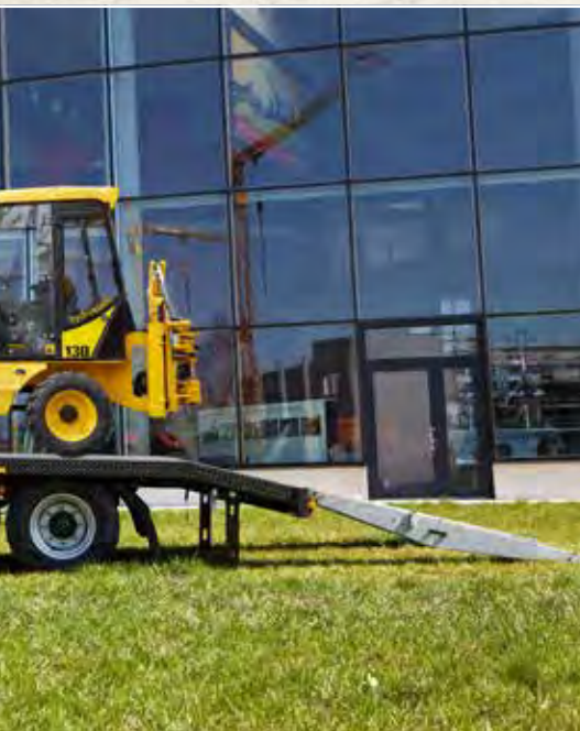
Auffharrampen mit Holz belegt, Brückenboden aus Stahlblech 3,5 mm lackiert beim TPA 120
