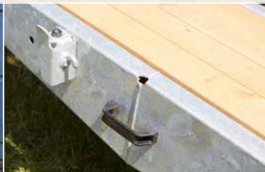
Auffharrampen mit Holz belegt, Brückenboden aus Stahlblech 3,5 mm lackiert beim TPA 120
