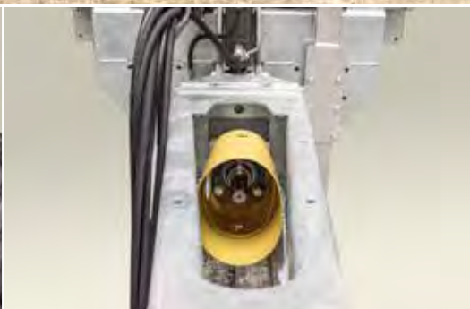
Über einen Zapfwellendurchtrieb wird das Streuwerk mechanisch angetrieben
