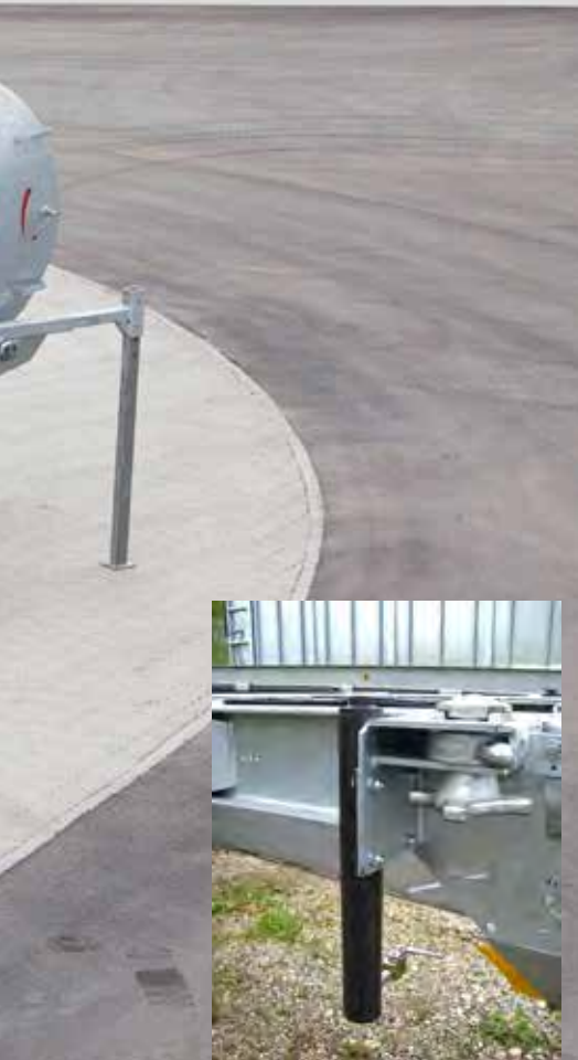
Zylinder für hydraulische Hebeeinrichtung
