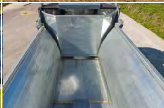
Geringster Verschleiß durch hydr. Schiebesystem – kein Kratzboden.
