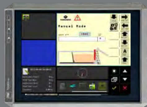
Das ISOBUS Multi-Control ist eine Multi-Maschinensteuerung. Es erlaubt das parallele Verwenden von FLIEGL VARIO SENS und z.B. FLIEGL TRAILER CONTROL. Das Multi-Control vereinfacht somit die Arbeit des Nutzers und steigert außerdem die Effizienz der Anwendung an sich.
