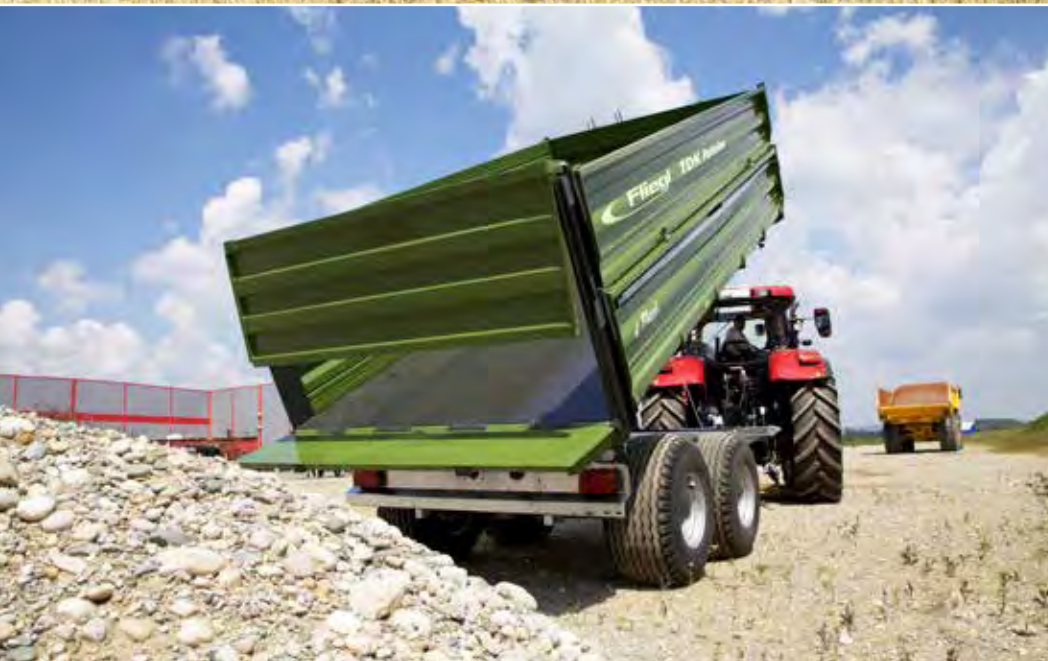
TDK 160 mit Aufbau 1800 mm (3 x 600 mm Bordwand)
