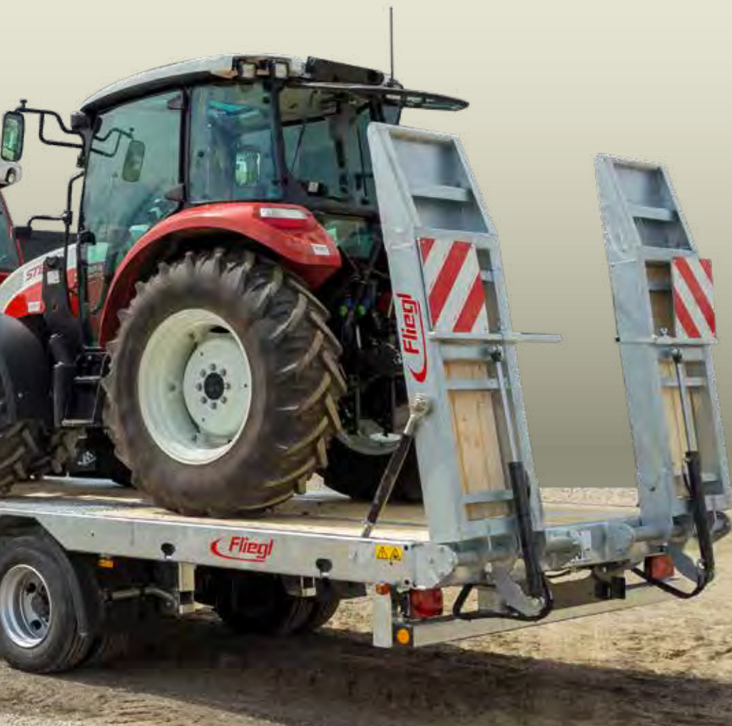
Der TPA 370 Stirnwand 800 mm in Serie Auffharrampen klappbar
