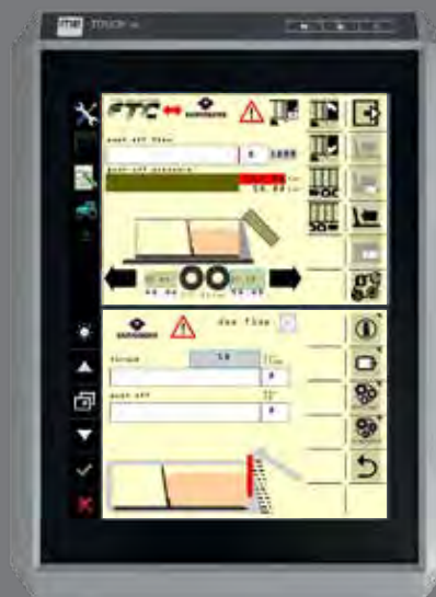
Das ISOBUS Multi-Control ist eine Multi-Maschinensteuerung. Es erlaubt das parallele Verwenden von FLIEGL VARIO SENS und z.B. FLIEGL TRAILER CONTROL. Das Multi-Control vereinfacht somit die Arbeit des Nutzers und steigert außerdem die Effizienz der Anwendung an sich.
