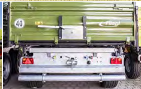
40 km/h Ausführung mit Unterfahrschutz und Kotflügel
