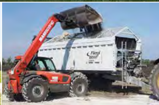
ASW 373 Tiger mit Schutzgitter gegen Fremdkörper
