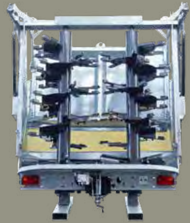
Fräswalzen mit Wurfschaufeln
