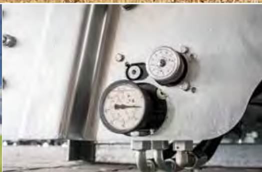
Mechanische Vorschubregelung über mechanisches Potentiometer
