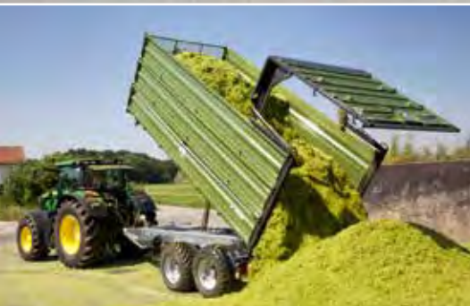
Silierkipper mit hydraulischer Rückwand
