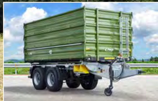
TDK 160 mit Aufbau 1800 mm (3 x 600 mm Bordwand)
