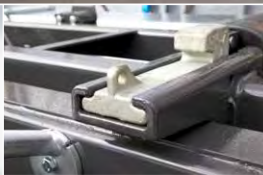
Umsteckbares Verriegelungssystem für Innen- und Aussenverriegelung
