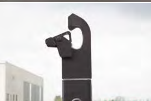
Geschmiedeter, einfach auswechselbarer Aufnahmehaken
