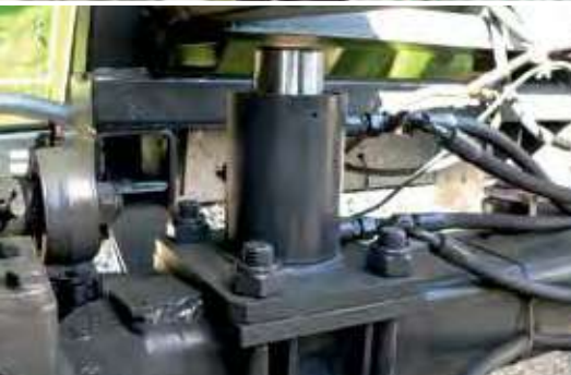
Optional: Hydraulische Abstützung auf die Achse
