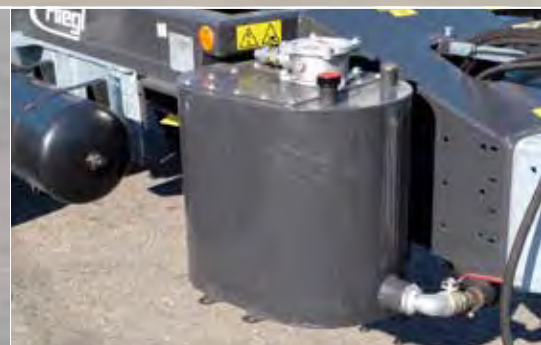
Bordhydraulik mit Gelenkwellenantrieb - optional
