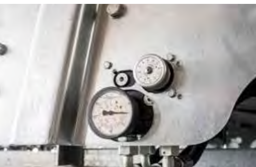
Mechanisches Potentiometer mit einstellbarer Vorschubgeschwindigkeit am Streuwerk
