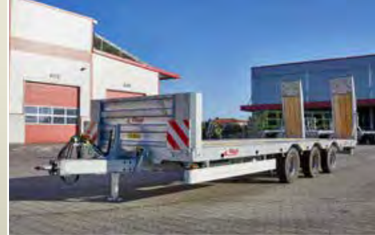
Der TPA 370 Stirnwand 800 mm in Serie Auffharrampen klappbar
