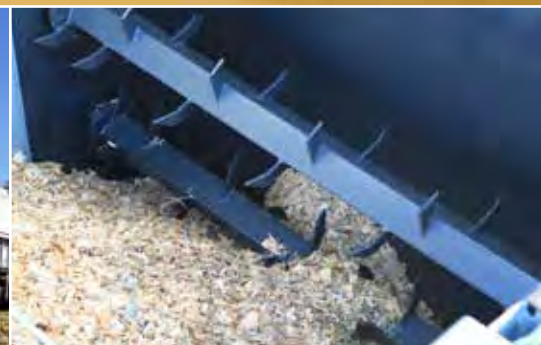
Fräsrollen sorgen für eine gleichmäßige Zuführung
