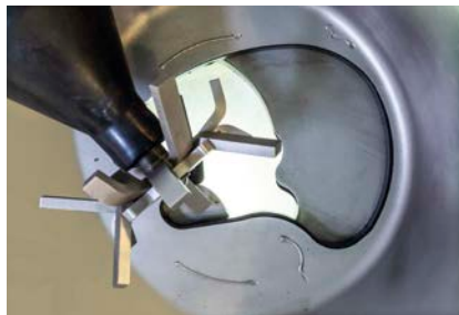
Stufe 2: Trichteröffnung halb geöffnet
