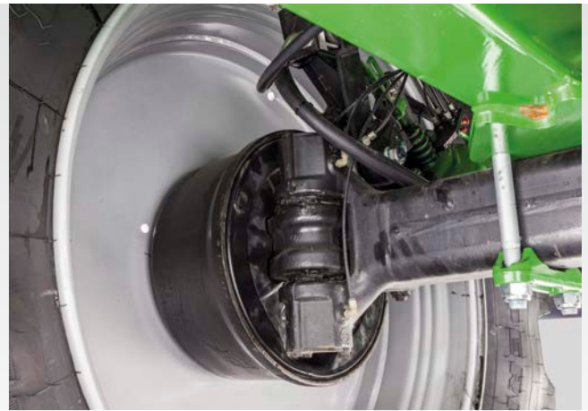
Bremskraftregelung durch elektronisches Bremssystem (EBS)
