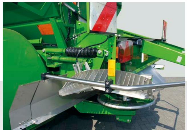
Grenzstreusystem Limiter hochgeklappt
