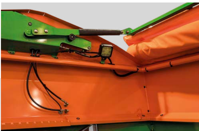
Arbeitsbeleuchtung im Behälterinnenraum
