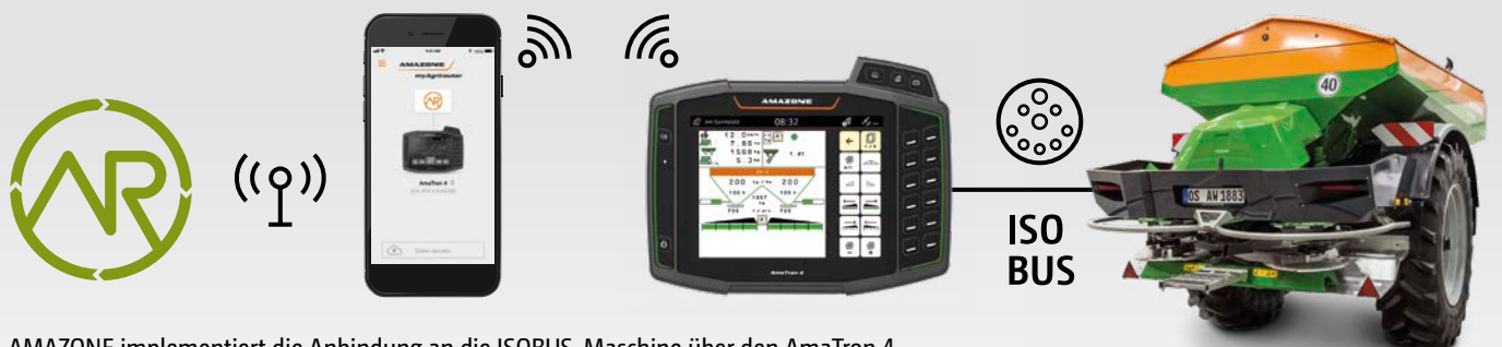
AMAZONE implementiert die Anbindung an die ISOBUS-Maschine über den AmaTron 4
