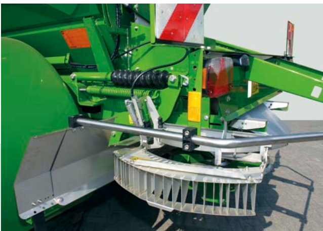
Grenzstreusystem Limiter in Arbeitstellung
