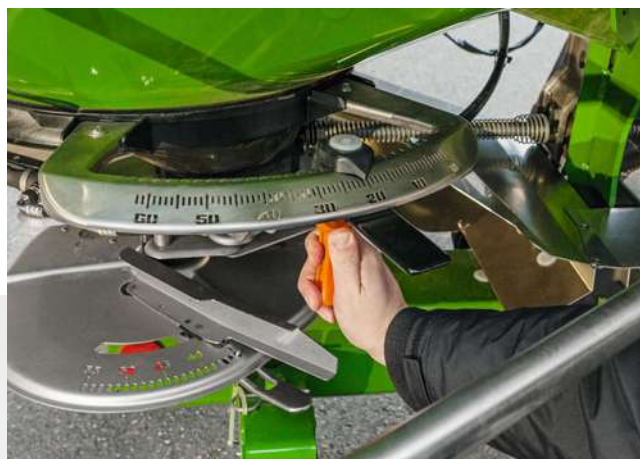
Einfaches Verstellen der Schieberkonsole mit großer Skala
