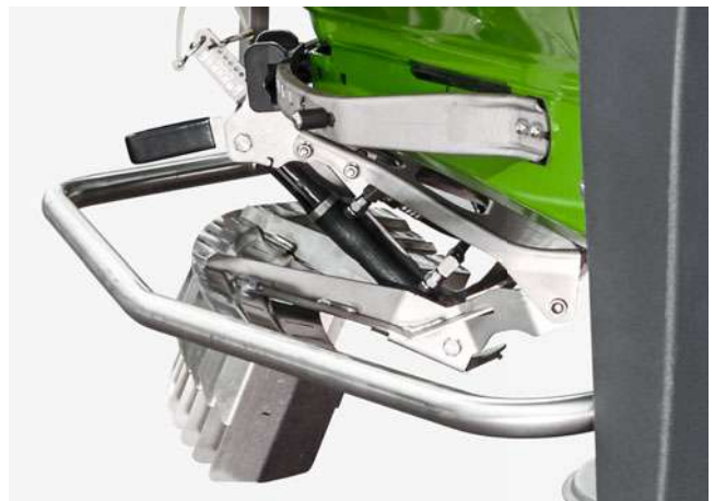
Hydraulische Grenzstreuvorrichtung Limiter V
