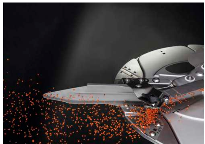
AutoTS – Einstellung der Einleitschaufel für Grenzstreuen
