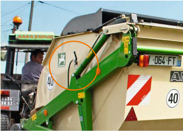
Hydraulische Zylindersperre für Grasshopper-Typen mit Hochkippentleerung
