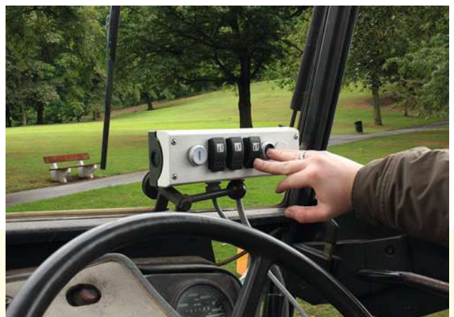
Eine komfortable Bedienung aller Hydraulikfunktionen erlaubt die Elektrohydrosteuerung bei den Produkttypen GHD, GHS und GHS Drive (Sonderausstattung)
