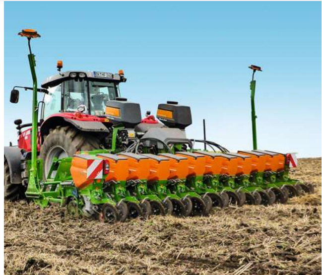
ED 6000 mit 12 Reihen und Mikrogranulatstreuer Micro plus
