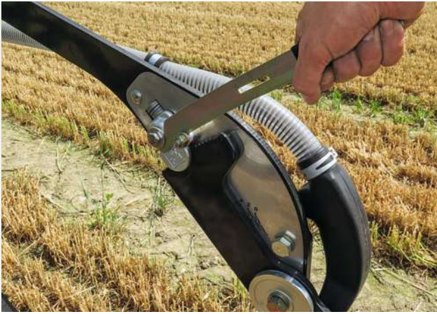
Einstellung des tiefengeführten Zinkenschars
