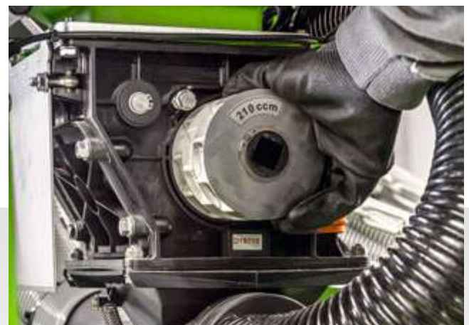
Einfacher Wechsel der Dosierwalze
