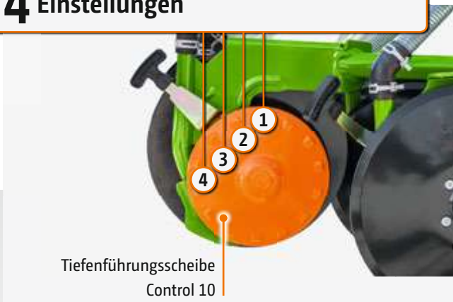
✓ RoTeC pro-Schar mit Tiefenführungsscheibe Control 10
