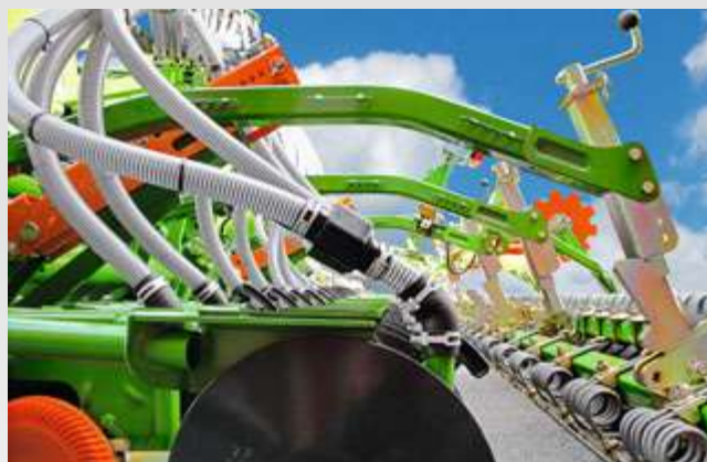
Sensor zur Erfassung des Saatgutstroms am Säschar
