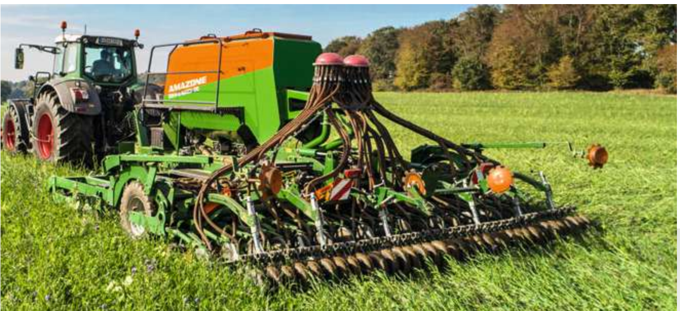
Cirrus 6003-2CC mit Minimum TillDisc-Scheibe
