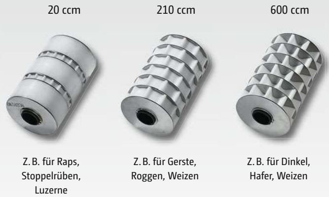
Dosierwalzen für verschiedene Saatgüter
