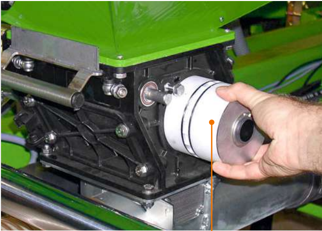
Die Dosierwalze ist auf der linken Maschinenseite schnell austauschbar
