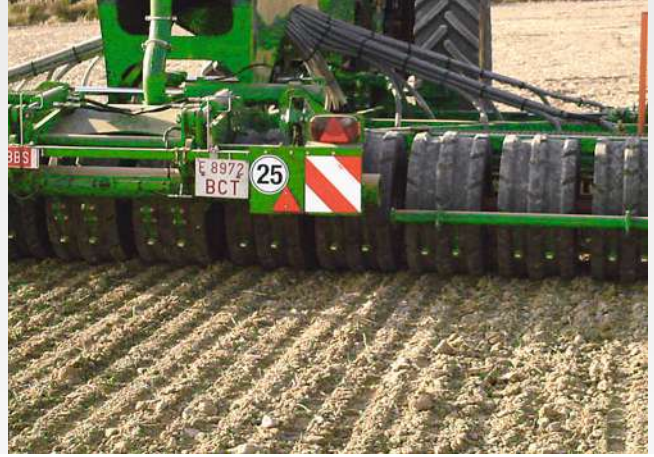
Keilringwalze mit Matrixreifenprofil
