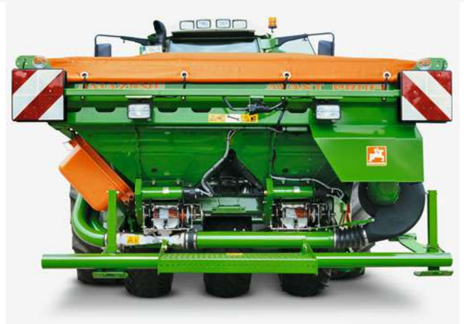
Zweispitziger Frontbehälter bei der 6 m breiten Avant mit zwei elektrischen Dosierantrieben für zwei Verteilerköpfe
