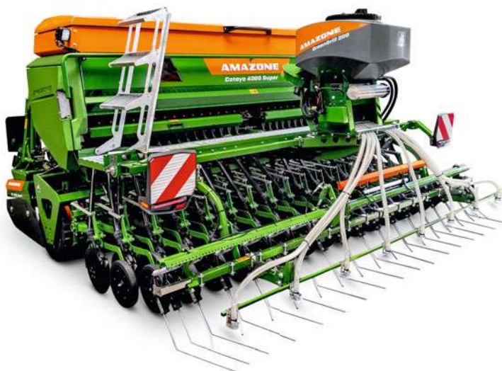
Cataya 4000 Super mit 4 m Arbeitsbreite, TwinTeC-Doppelscheibenschar mit Exaktstriegel und 1.730 l Behältervolumen
