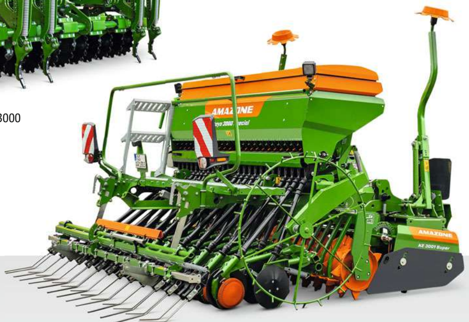
Kreiselegge KE 3001 Super mit der Aufbausämaschine Cataya 3000 Special
