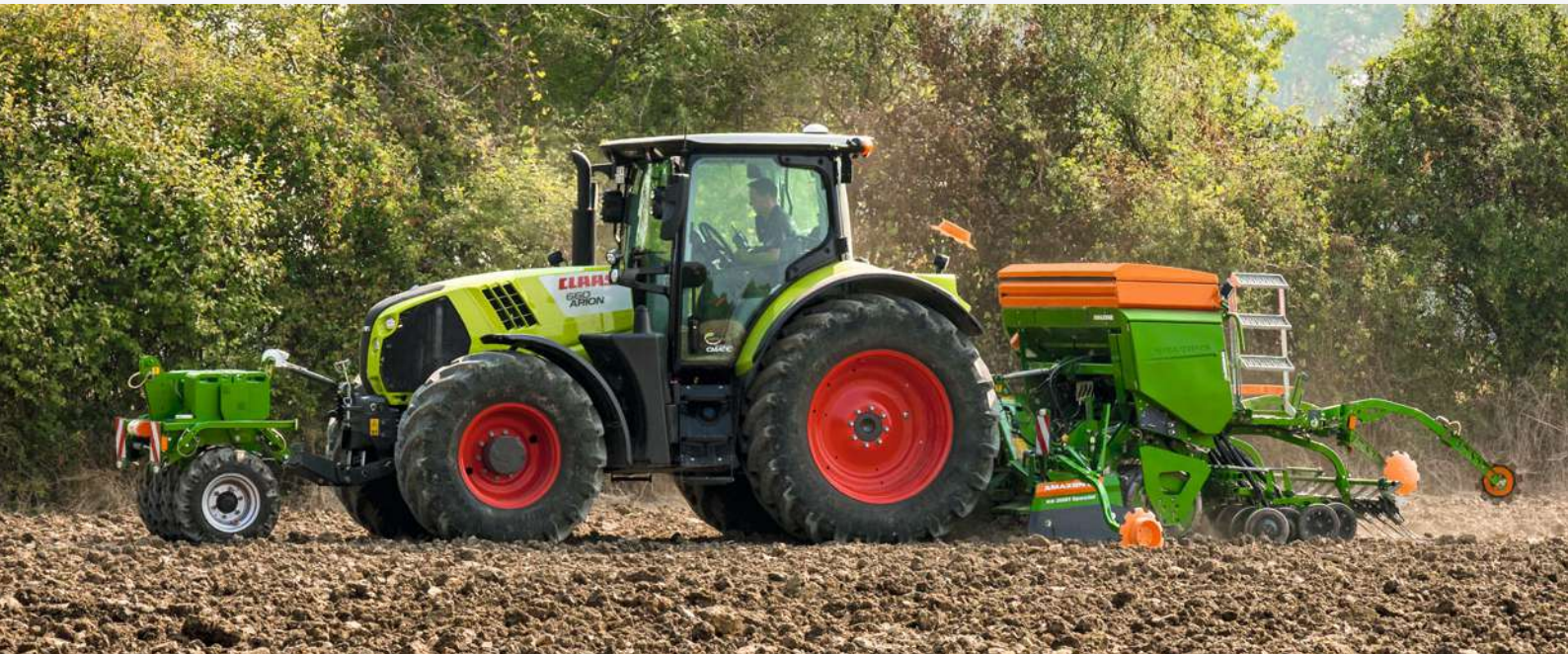
Die Cataya 3000 Super mit Reifenpacker T-Pack U bei der Pflugsaat
