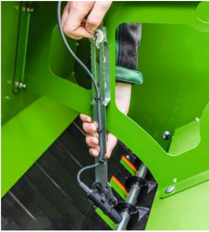
Einfachste Umstellung von Fein- auf Normalsaat mittels Schliebschieber
