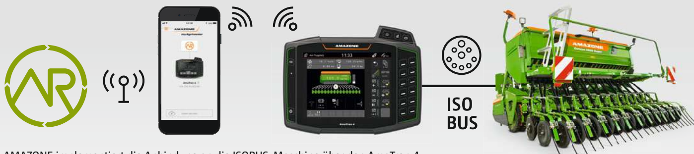
AMAZONE implementiert die Anbindung an die ISOBUS-Maschine über den AmaTron 4
