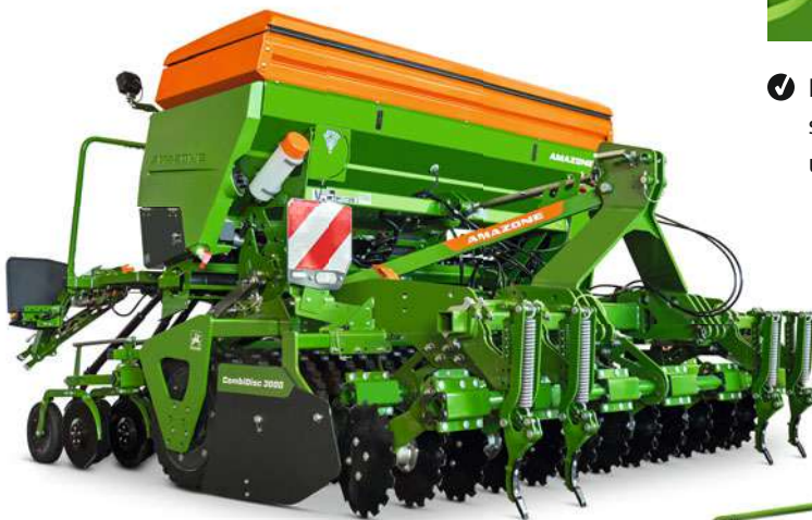
Anbau-Kompaktscheibenegge CombiDisc 3000 mit Aufbausämaschine Cataya 3000 Super
