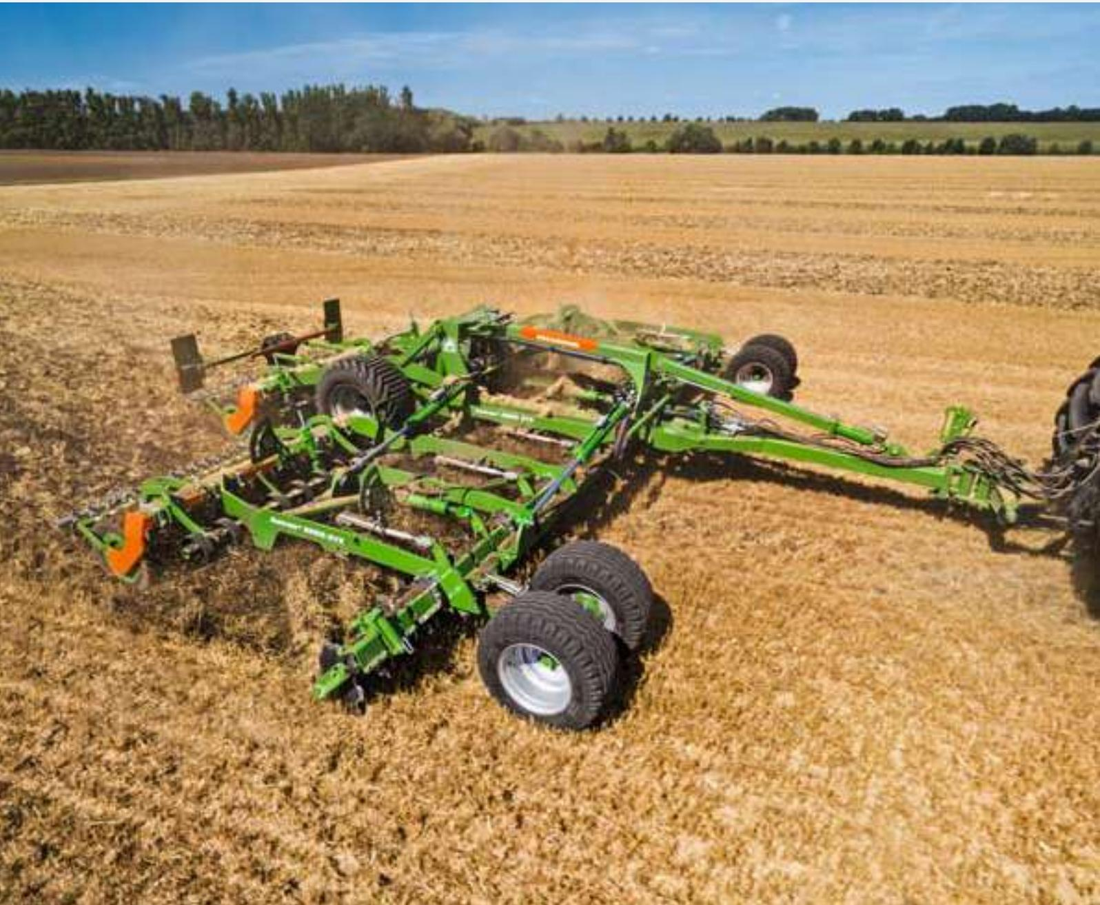
Catros<sup>+</sup> 8003-2TX mit Keilringwalzen mit Matrixreifenprofil in 8 m Arbeitsbreite
