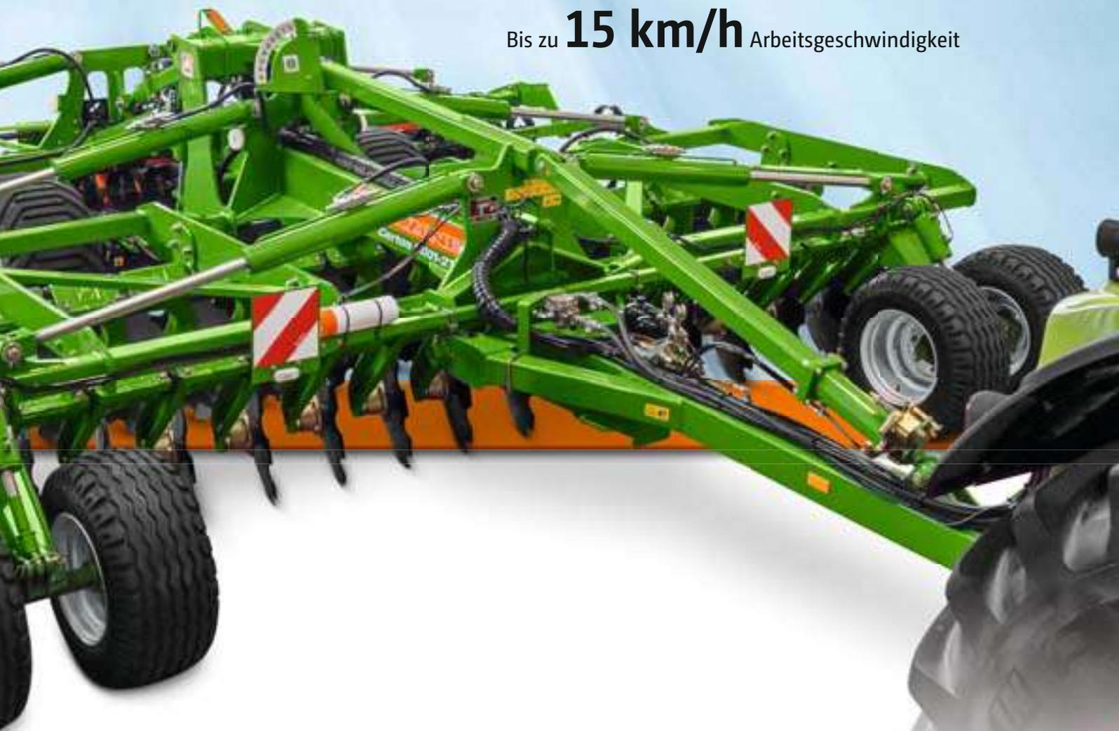
Die Anhängescheibenegge Certos-2TX eignet sich ideal für die intensiv mischende Bodenbearbeitung bis hin zur mitteltiefen Bodenbearbeitung. Mit den 660 mm großen Scheiben dringt die Certos-2TX bis zu 20 cm tief in den Boden ein und arbeitet auch große Mengen organischen Materials verstopfungsfrei ein. Dank seines breiten Arbeitspektrums bietet die Certos-2TX mit Arbeitsbreiten von 4 m bis 7 m kraftvolle Allrounder für jeden Betrieb.
