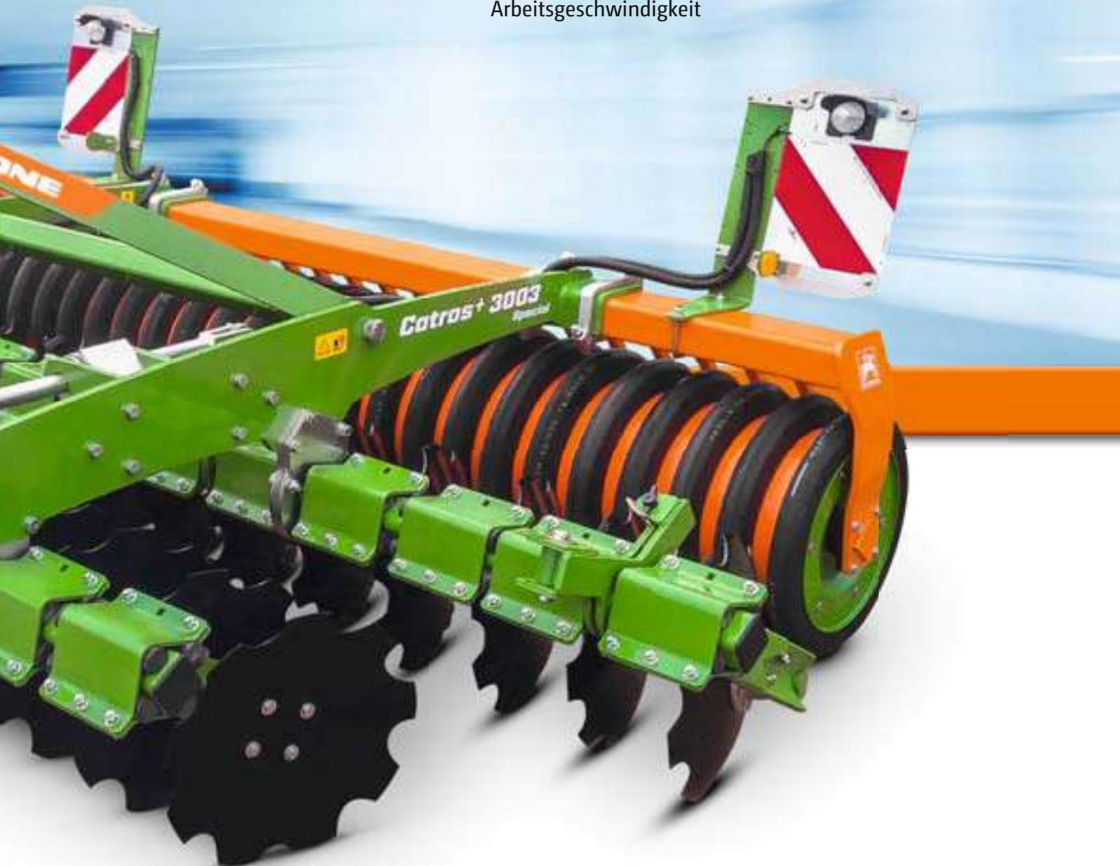
Die Anbauscheibenegge Catros Special eignet sich ideal für die schnelle, flache und intensiv mischende Bodenbearbeitung. Mit solider verbauter Technik ist sie in den Arbeitsbreiten von 2,5 m bis 4 m das ideale Einstiegsmodell für kleine bis mittelgroße Betriebe.
