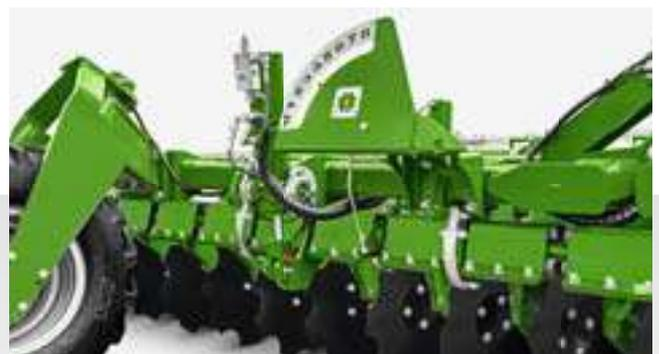
Hydraulische Arbeitstiefenverstellung mit gut ablesbarer Skala
