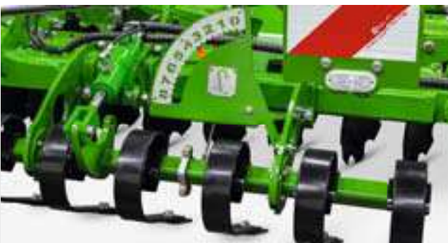
Crushboard mit hydraulischer Tiefenverstellung und übersichtlicher Skala
