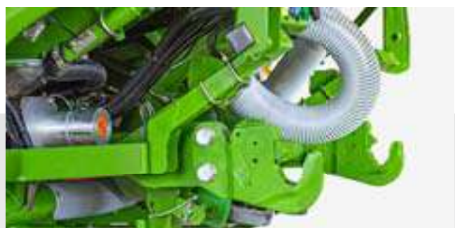
Unterlenkeranhängung für nachlaufenden Cenius-2TX
