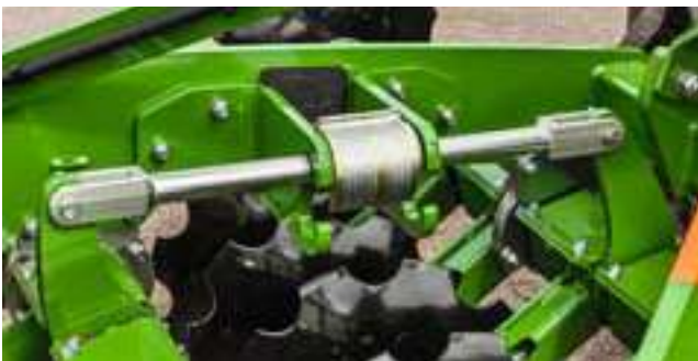
✔ Arbeitstiefeneinstellung durch Distanzelemente – hier flache Arbeitstiefe
