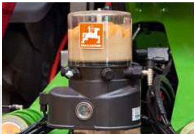
Pumpe mit Vorratsbehälter
