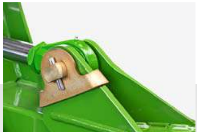
Hochfeste Bolzen und Verdrehsicherungen im pro-Paket
