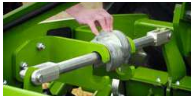
✔ Arbeitstiefeneinstellung durch Distanzelemente – hier mittlere Arbeitstiefe
