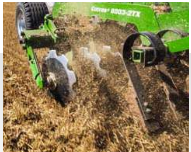
Crushboard mit hydraulischer Tiefenverstellung und übersichtlicher Skala
